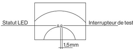
Remarque : appuyez avec prudence sur l'interrupteur de test afin d'éviter de l'endommager.
