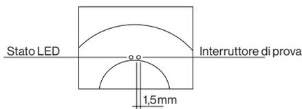
Nota: premere l'interruttore di prova con cautela per non danneggiarlo.
